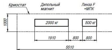
Рис. 7.3.5. Схема компоновки измерительного периода Коллайдера
